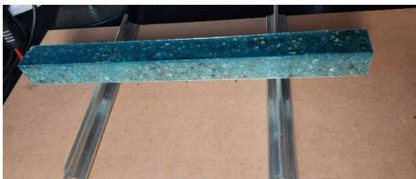
Фиг. 3. Опитна установка за определяне на f_f
